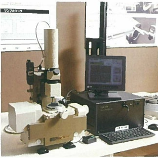
同社オリジナルの光学式非接触小径内径測定器。右のタッチパネルを操作して、左の機器で測定を行う。
