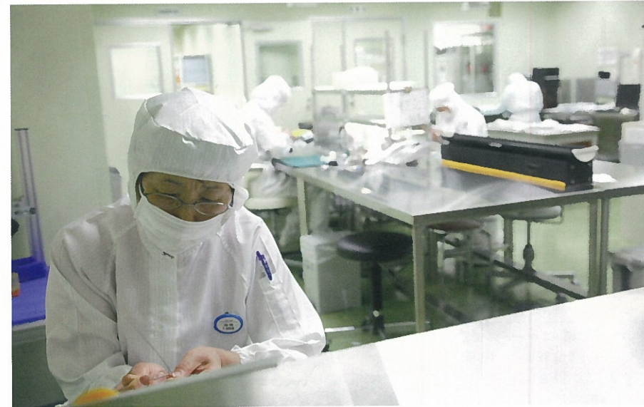
クリーンルームでのカテーテル組立作業。全数検査を行って品質を厳しくチェックする
